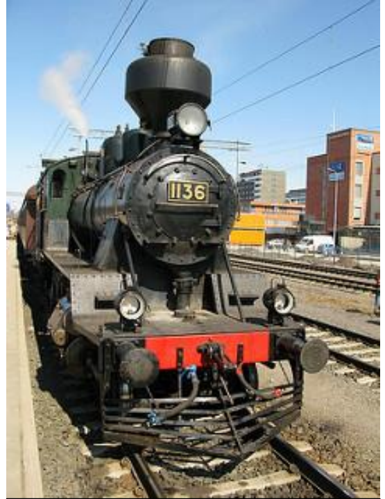
Tk3, lempinimi Pikku-Jumbo , on kevyt tavarajunaveturi. Vetureita rakennettiin kaikkiaan 161 kappaletta vuosina 1927–1953
